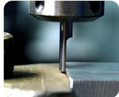
Die Z-Achse wird sehr ähnlich wie bei den X/Y-Achsen referenziert, wobei die Z-Achse ein bisschen nach oben über das Materialniveau hochgehoben und dann im Schrittbetrieb so lange gesenkt wird, bis die untere Oberfläche der Welle das Material berührt. Und klicken Sie natürlich auf „Zero Z“, um die Z-Koordinate an dieser Stelle zurückzusetzen.
