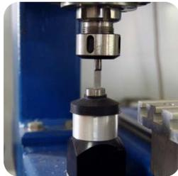
Wie am Anfang erwähnt, wird eine Hartmetallwelle, die bis auf die Hälfte seines Durchmessers geschliffen ist, zur Referenzierung des Materials verwendet. Wenn Sie die Funktion zur Feststellung der Werkzeuglänge benutzen wollen, geben Sie ins Feld „Tool“ des Mach3-Programms die Werkzeugnummer „1“ ein und lösen Sie die Messung aus, indem Sie die Schaltfläche „Auto Tool Zero“ betätigen.
