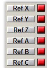
Überprüfen Sie die Referenzierung aller verwendeten Achsen, indem Sie die Schaltflächen Ref... nacheinander betätigen. Nach erfolgreich abgeschlossener Referenzierung sollte die neben der Schaltfläche stehende Kontrollleuchte auf grün wechseln. Falls Sie beim Auslösen der Referenzierung feststellen, dass die Bewegung in falsche Richtung erfolgt, kann die Konfiguration im „Config→Homing/Limits“ korrigiert werden.
