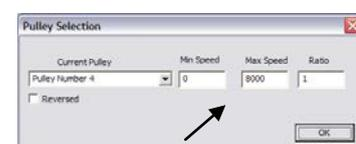
wendet wird, geben Sie in den Feldern „Min“ und „Max“ nur die minimale und maximale Drehzahl ein. Bestätigen Sie das mit „OK.“
