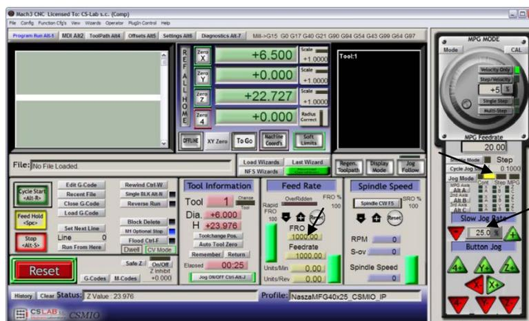
Jetzt fahren Sie mit den Pfeiltasten oder den Tasten am Bedienpult der Maschine an den linken Rand des Materials an. Die Z-Achse befindet sich ein wenig unterhalb des Materialniveaus.
