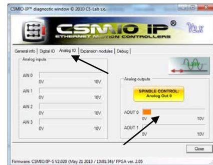
Zudem informiert das Symbol Sie darüber, welcher Analogausgang zur Spindelsteuerung konfiguriert ist.
