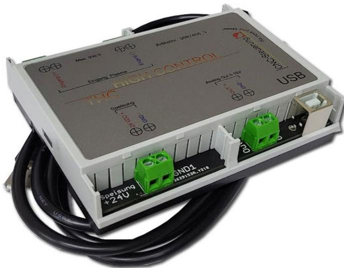
Das Trennverstärkermodul im geschlossenen Gehäuse verfügt über einen Analogausgang (0-10V), der auf zwei Schraubklemmen (Out / Gnd) beschaltet ist.
