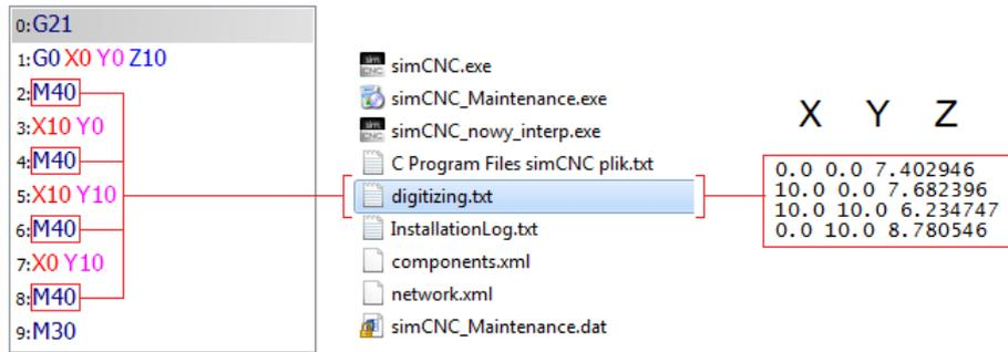
Falls die Sonde auf der durch den Parameter festgelegten „Distance“ nicht anspricht, wird in der Datei „digitizing.txt“ der Eintrag „Probing Failed !!!“ gespeichert.
