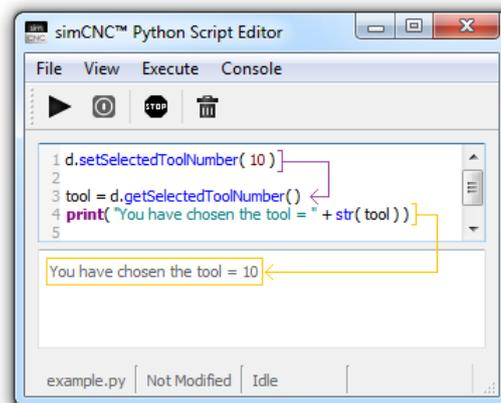
Es ist einfach zu sehen, dass die Funktion `d.setSelectedToolNumber( 10 )` genau dieselbe Aufgabe erfüllt wie der Befehl T10, der mithilfe des gcod bzw. MDI-Zeile abgerufen wird.
