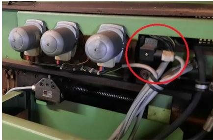
Der zur Spindelschmierung gehört, wird am Stecker **T\_S** angeschlossen.
