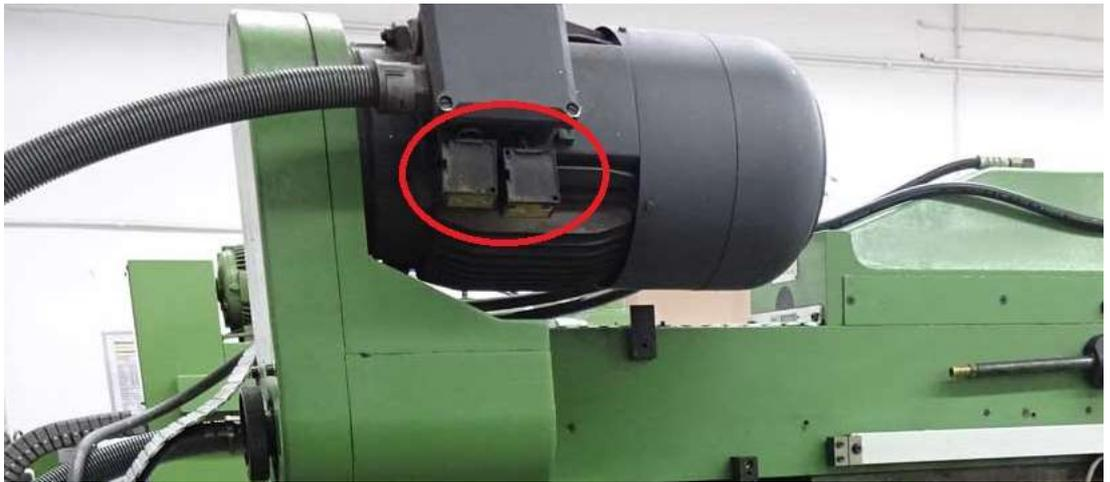
Schließen Sie den Motor auf eine Drehzahlstufe an.
