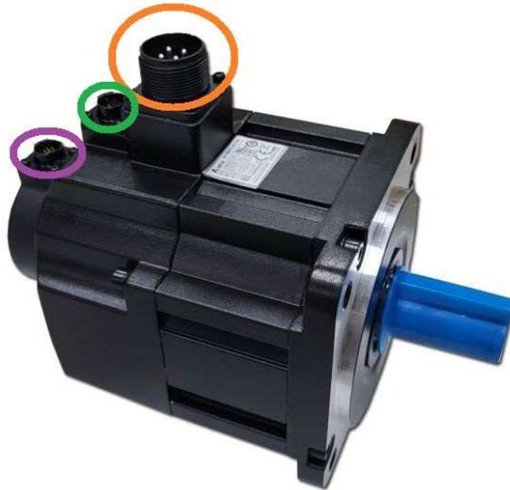
Das Motorkabel (Orange) schrauben Sie auf den Motor (siehe Bild Oranger Ring)
